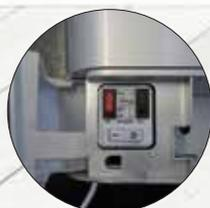
Pannello di controllo che permette un rapido e agevole accesso ai dispositivi di settaggio manuale: on/off, selezione velocità e selezione resistenza.
